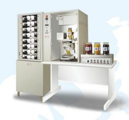
新一代母液自動稀釋裝置,自動泡製稀釋母液,方便、迅速、確實,調製母液過程,透過RFID系統管理,減少人為疏失,迅速精準,提供智能染料櫃(選配),自動旋轉,配備LED燈號顯示,方便使用者取放染料罐。
