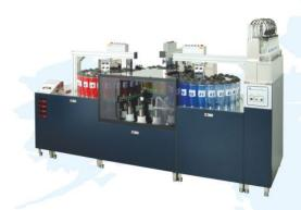
新型無管路滴液,再現性好轉盤式滴液,滴定速度快 重量法計量,可記錄實際滴液量 採可程式控制模式,效率高
