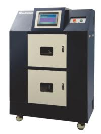
本機是一部多用途化驗室試色實驗機,採用專利的導熱設計,配備精密染程溫控器,可精確控溫。每只染杯皆配備獨立加熱器及測溫裝置,可應用在常溫或高溫染色,達到每一杯依升溫曲線控溫精確之目的。提供人機介面裝置,可作為編輯染程、染程執行中的各杯狀態即時顯示、查詢染程執行紀錄、提供USB做資料備份及上傳、提供RS485與中控系統連線共用資料等,操作更為簡便。
